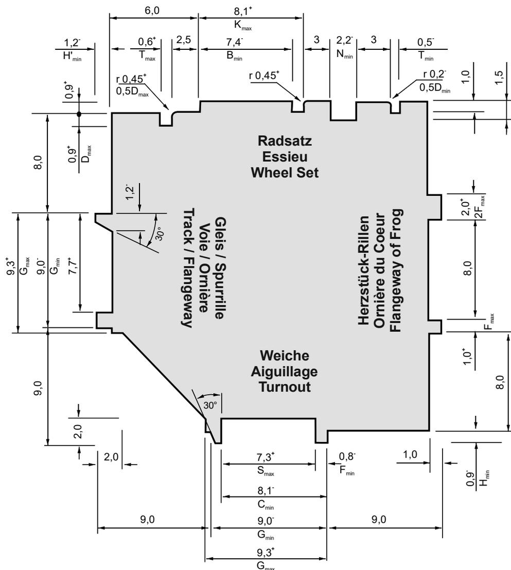
Toleranzen der Lehre: <sup>+</sup> bedeutet +0,03 - 0 <sup>-</sup> bedeutet +0 - 0,03 Freimaßtoleranz 0,5
