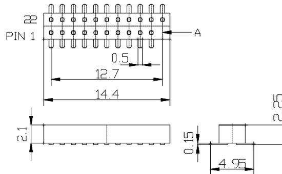
Figure 2 : barrette à douilles typique, A=position du détrompeur Pin 11
